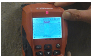
Bewehrungssuche zur Bestimmung der Injektionskanäle
